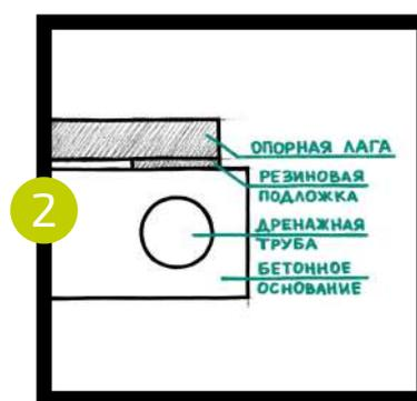
**Бетонное основание (литая бетонная плита) – сплошная, ровная, гладкая, чистая поверхность.**
